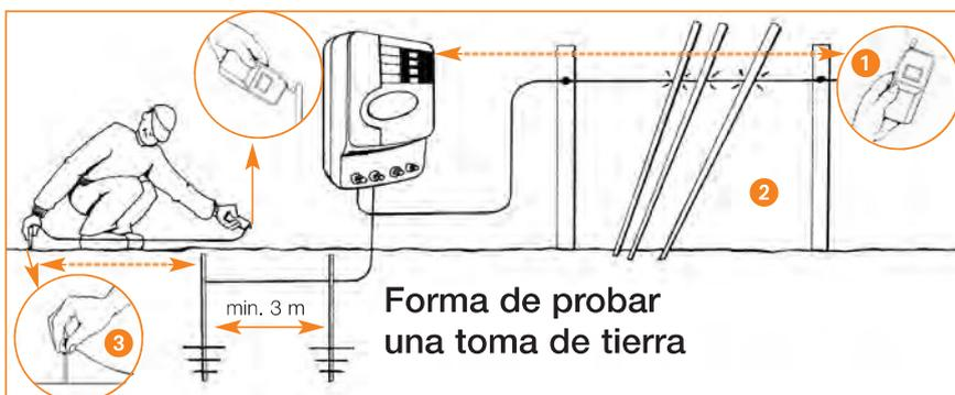
Para realizar una toma de tierra adecuada se necesita utilizar picas galvanizadas tanto para energizadores a 230 V, como para energizadores a batería. Para realizar las uniones, utilizar una abrazadera y cable doble aislado. Si necesita más de una varilla de toma de tierra, deben de separarse al menos tres metros de distancia. Si el suelo es arenoso o suelo muy seco, le recomendamos utilizar una toma de tierra adicional o el uso de la mezcla especial de toma de tierra de bentonita (Ref. P49063).
